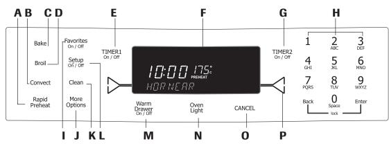
El panel de control está diseñado para una programación sencilla. La pantalla muestra las opciones para cada función y va indicando los pasos del proceso de programación. Las características del panel de control varían según el modelo. La pantalla del horno está programada para horneado.
